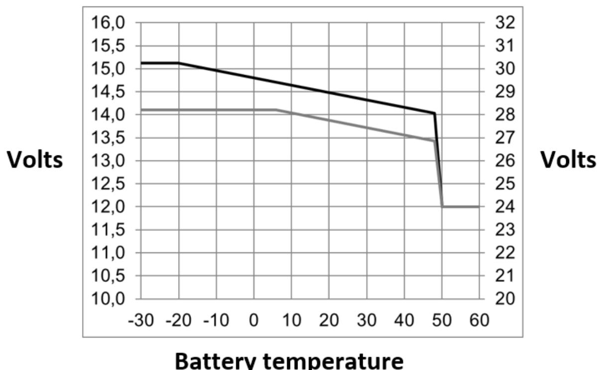
Le tableau ci-dessus indique les tensions de sortie par défaut pour les modes Float et Absorption à 25 °C pour des parcs de batteries de 12 et 24 V. Pour un parc de batteries de 48 V, multipliez les tensions de 24 V par 2.
