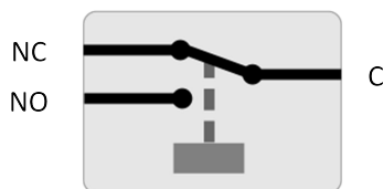
Fonctionnement interne du relais programmable
